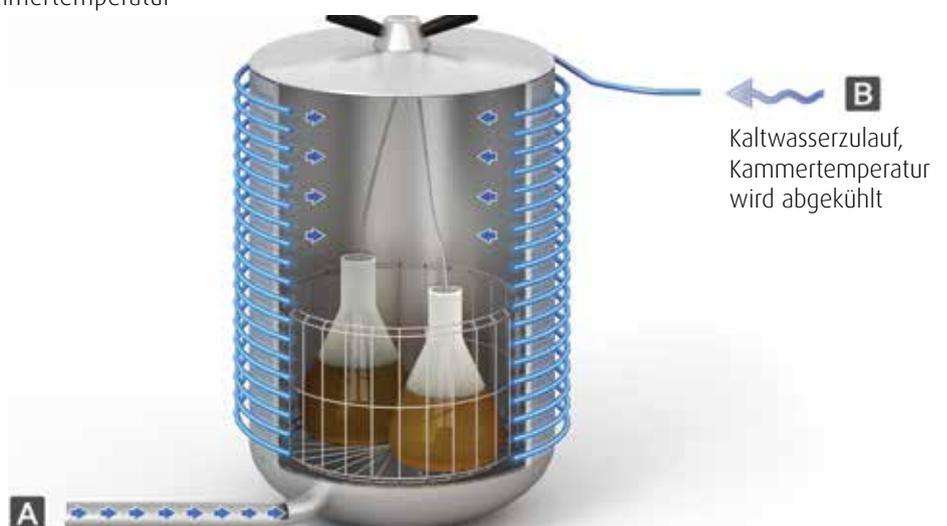
Kaltwasserzulauf, Kammertemperatur wird abgekühlt
