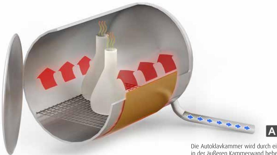
Die Autoklavkammer wird durch eine Heizplatte in der äußeren Kammerwand beheizt.
