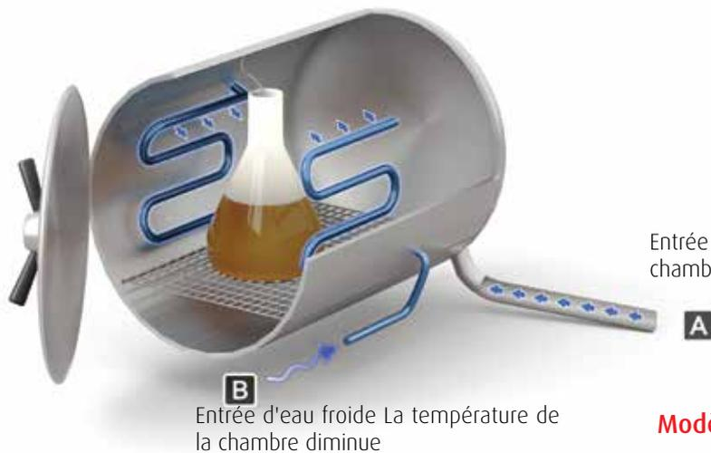
Entrée d'air comprimé La chambre est pressurisée
