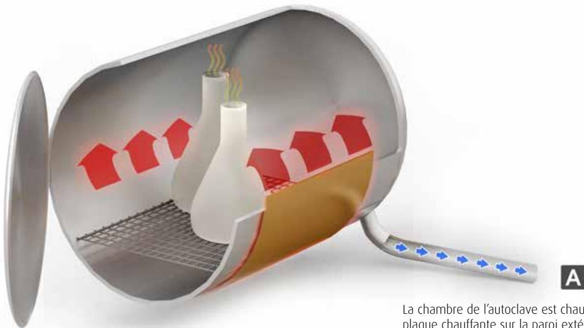
La chambre de l'autoclave est chauffée par une plaque chauffante sur la paroi extérieure de la chambre.
