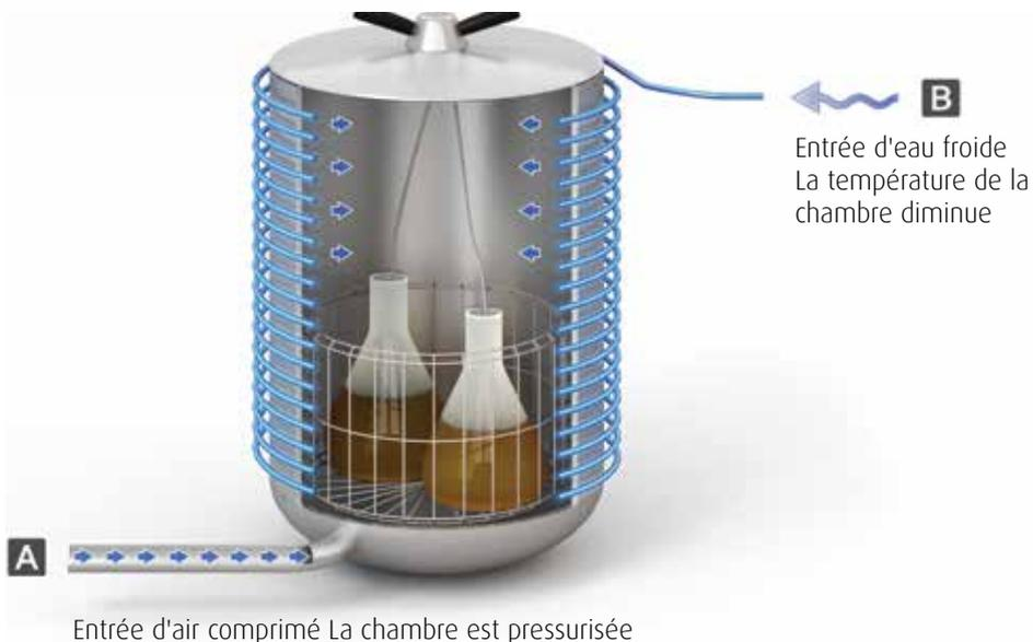
Entrée d'air comprimé La chambre est pressurisée
